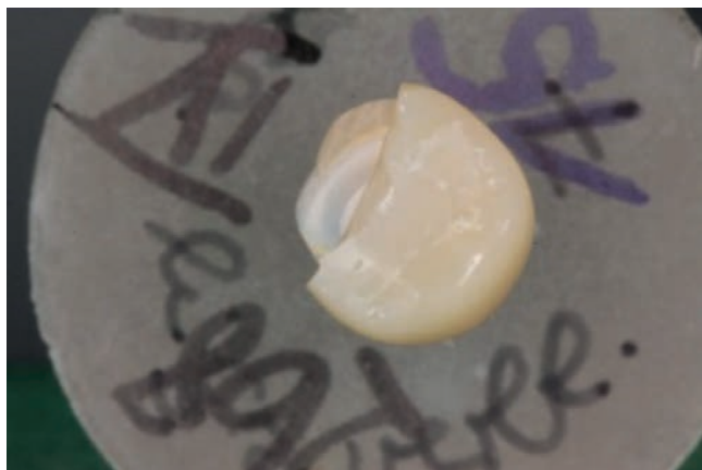
Рис. 44: Повреждение коронки в процессе моделирования жевательной нагрузки после 960 000 циклов. 59)
