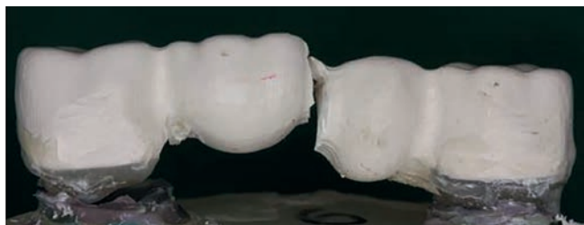
Рис. 33: Фрактура моста, изготовленного из BioHPP посредством системы CAD/CAM. 43)
