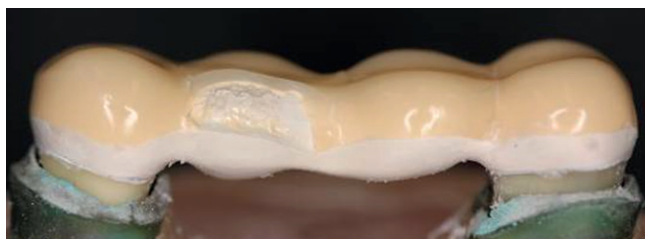
Рис. 39: Мост с отколотой облицовкой после испытания под нагрузкой. 52)
