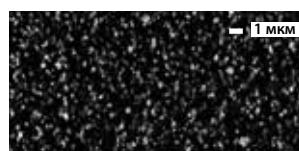
Однородная и мелкозернистая поверхность BioHPP «БиоХПП» при 1000-кратном увеличении под электронным микроскопом.
