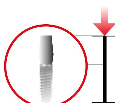
Компенсация отсутствует. Протез из твердых материалов (Титан или Цирконий) передает пиковые нагрузки жевательного усилия 1:1 на имплантат и челюстную кость.
