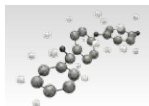
Структурная формула молекулы ПЕЕК. Белым облаком обозначен керамический наполнитель, обеспечивающий механические свойства материала, соответствующие требованиям, необходимым для применения материала в области зубного протезирования.
