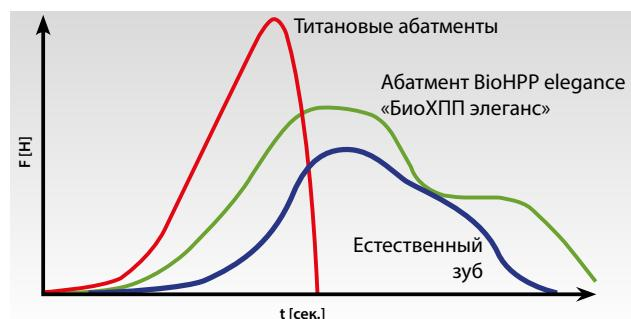
BioHPP «БиоХПП» компенсирует отсутствие естественного демпфирования шарпееевыми волокнами. Эластичность BioHPP «БиоХПП» снижает пиковые нагрузки при жевании и обеспечивает передачу силового воздействия через имплантат на кость в течение более продолжительного времени. Это обеспечивает возможность немедленного протезирования с помощью имплантатов и оптимальную остеоинтеграцию.
