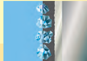
Алмазные кристаллы в нанесенном на металлическую поверхность гальваническом покрытии.
